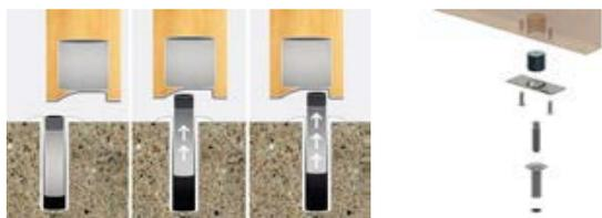
Der magnetische Türstopper wird an einer eigens dafür gefrästen Stelle in Eigenregie montiert.
